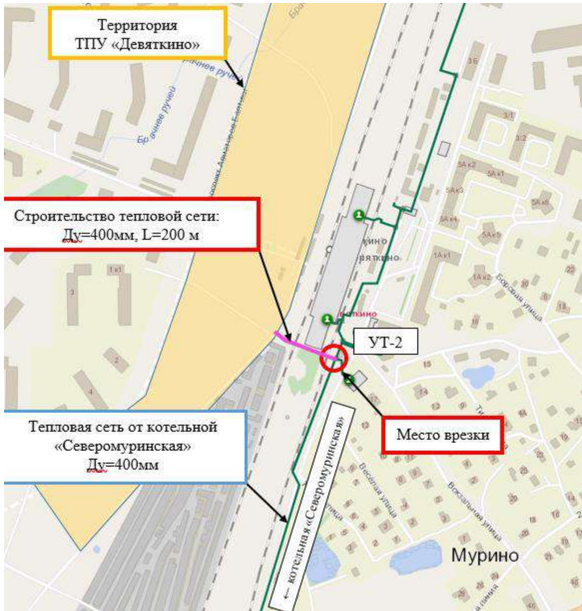
Рисунок 10 Вариант подключения ТПУ «Девяткино» от существующих тепловых сетей ГУП «ТЭК СПб»
